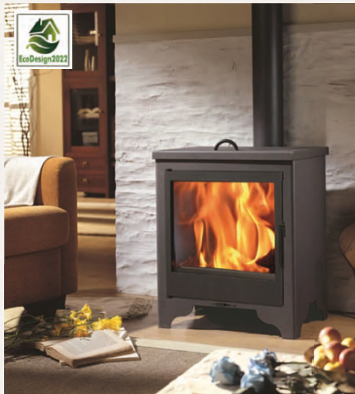
SALAMANDRA OSLO PANADERO Grelha e porta em ferro fundido, dupla combustão, corpo duplo em aço 4 + 3 mm, sistema de vidro limpo, volume de aquecimento 180 m3, potência 8 kW, rendimento 77%, saída de fumos horizontal 120-125 mm. Dimensões 720x529x507 mm, peso 89 kg. ESTÁ EM CONFORMIDADE COM OS REGULAMENTOS ECODESING 2022
